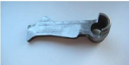
Der CHD Wert (engl. = Case Hardness Depth) gibt Auskunft über die Einsatzhärte tiefe des wärmebehandelten Bauteils. Dieser Wert wird durch den senkrechten Abstand zur Grenzhärte von 550HV ermittelt. Die Einhärtungstiefe nach den Randschichthärten wird als RHT bezeichnet. Dies ist der Abstand zwischen der Oberfläche und der Grenzhärte, welche 80% der Oberflächenhärte beträgt.
